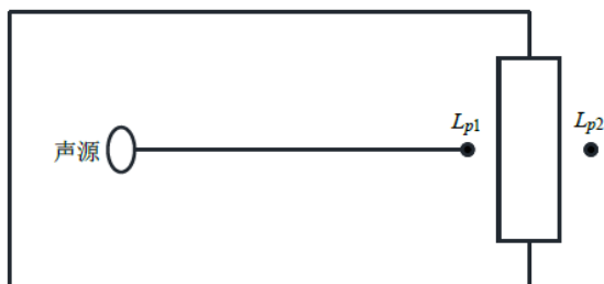
图 6.2.3-1 室内声源等效为室外声源图例
